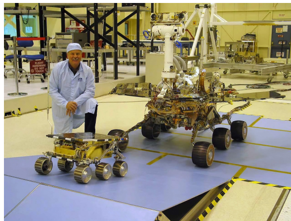
Figura 1.1: Robôs exploradores de Marte: Spirit e Sojourner da NASA
