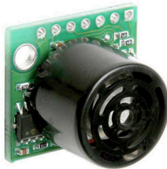
Figura 3.6: Sensor de distância ultra-sons LV-MaxSonar ® -EZ0 ™ .
